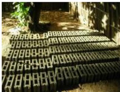
高さ2メートルの外壁を作るのに必要なブロックはおよそ1200個。一つずつ手作業で、セメントを混ぜ、型を抜き、乾燥させ、ブロックづくりを行っています。5月中には1200個完成予定です。
